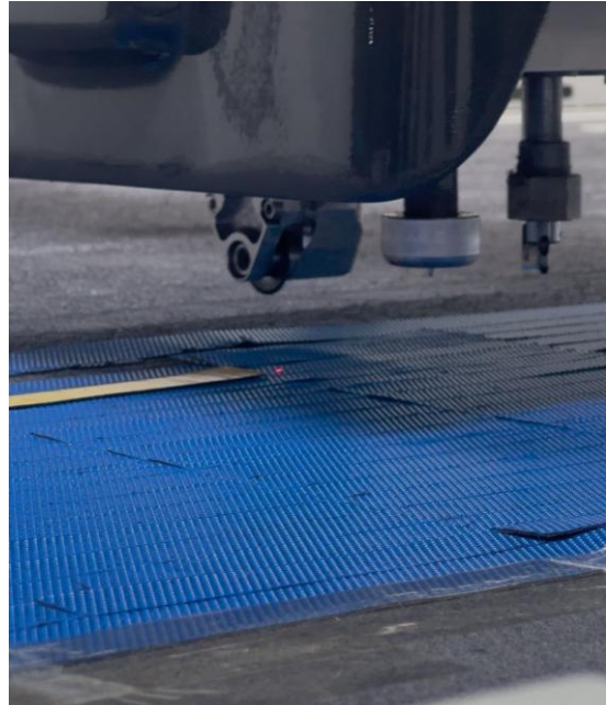
Prepreg Karbon Fiber Kumaşın CNC Kesimi
