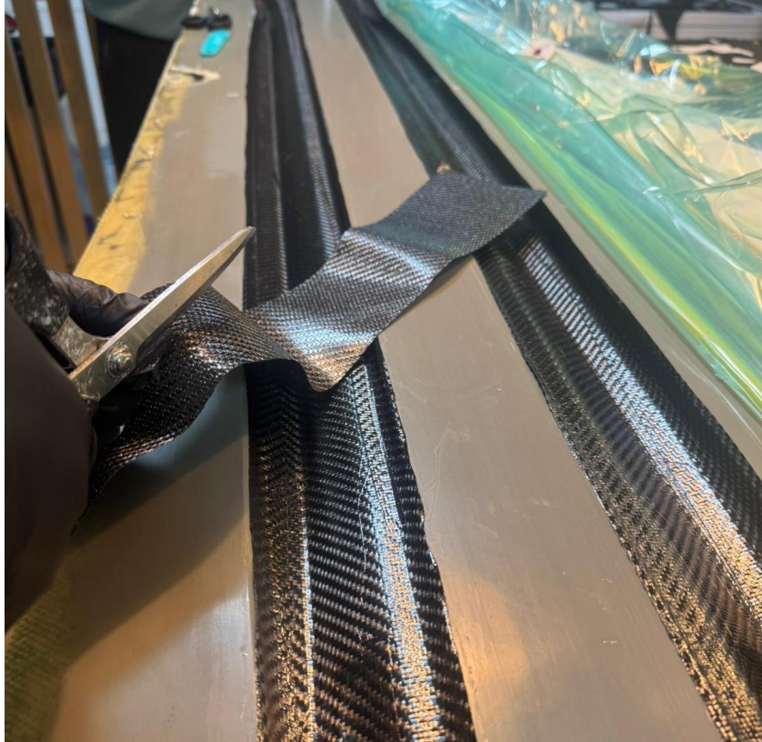
Prepreg Karbon Fiber Laminasyon Süreci
